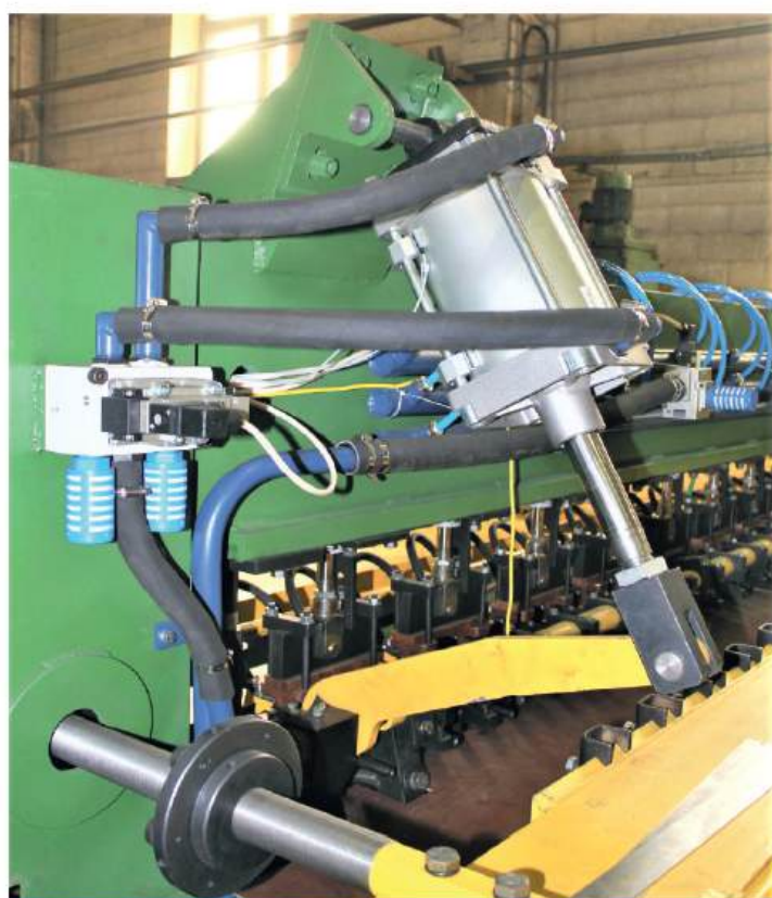
Узел реза поперечной арматуры
