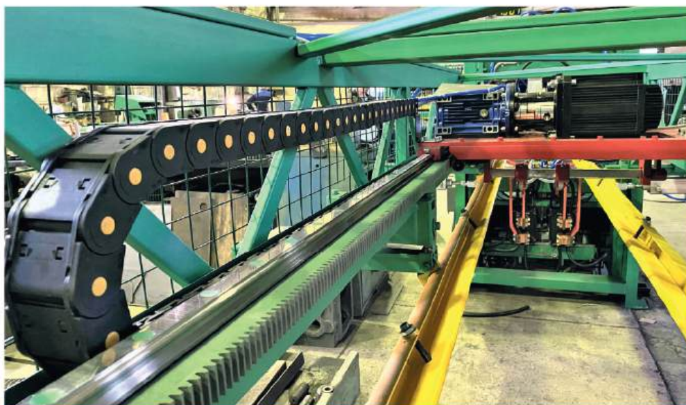
Комбинированный узел каретки и приёмного стола
